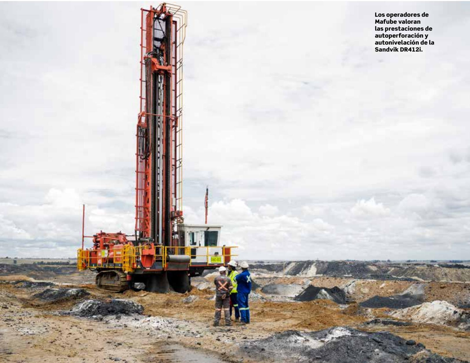
Los operadores de Mafube valoran las prestaciones de autopercusión y autonivelación de la Sandvik DR412i.
