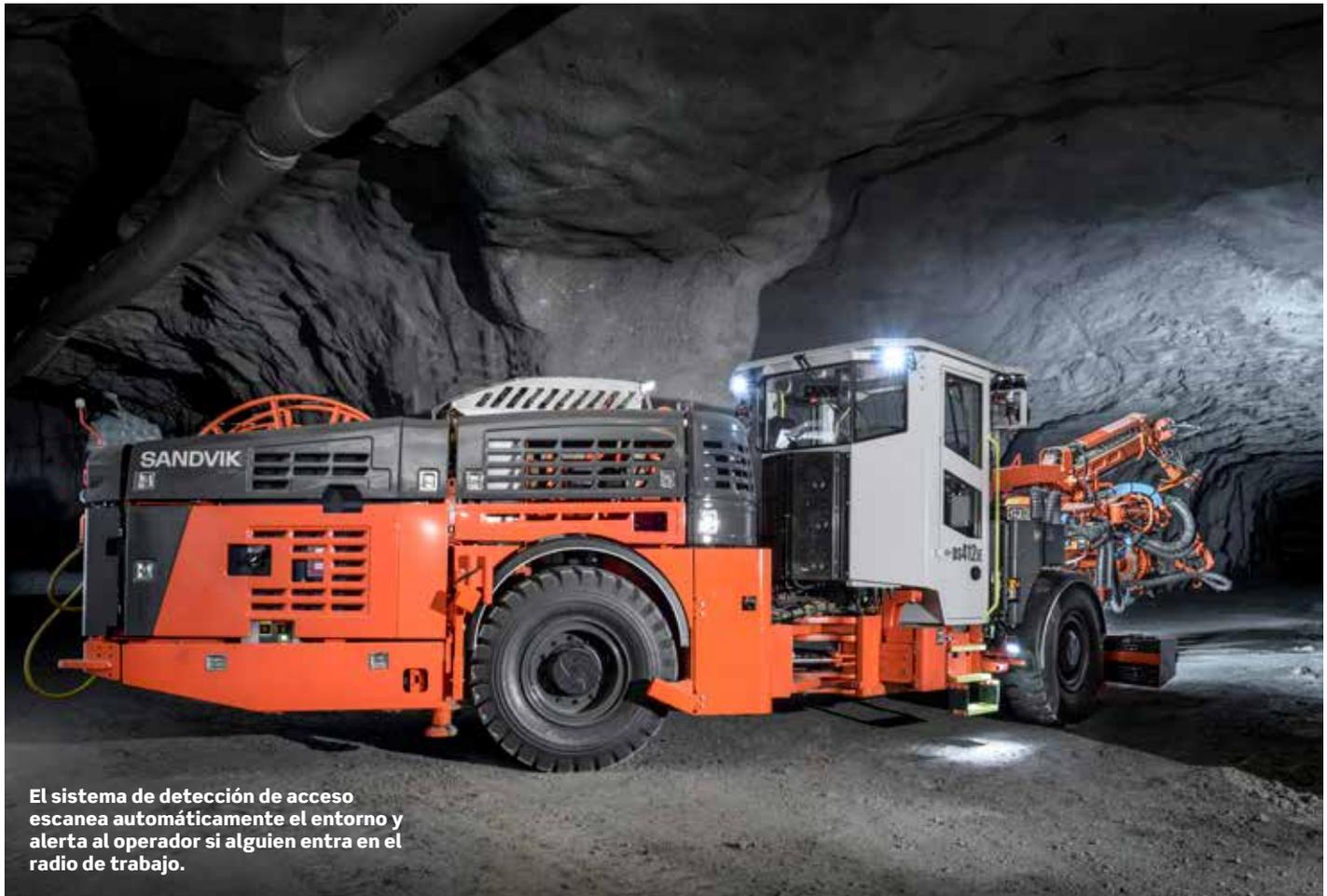
El sistema de detección de acceso escanea automáticamente el entorno y alerta al operador si alguien entra en el radio de trabajo.
